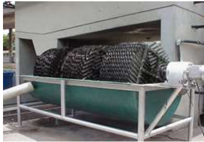
Figura VII.8. Biodiscos rotatorios de la Planta Experimental de Tratamiento de Aguas, UCV.
